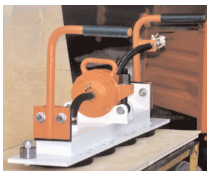
Niveladora de concreto
